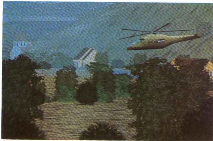
A gauche, le simulateur, à droite le paysage : une caméra, montée sur rail se déplace en fonction des choix du pilote. Gare aux arbres !
